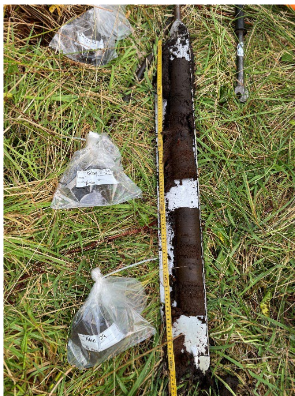
Figur 4: Russerbør (russian peat corer) med 1m kasse.
